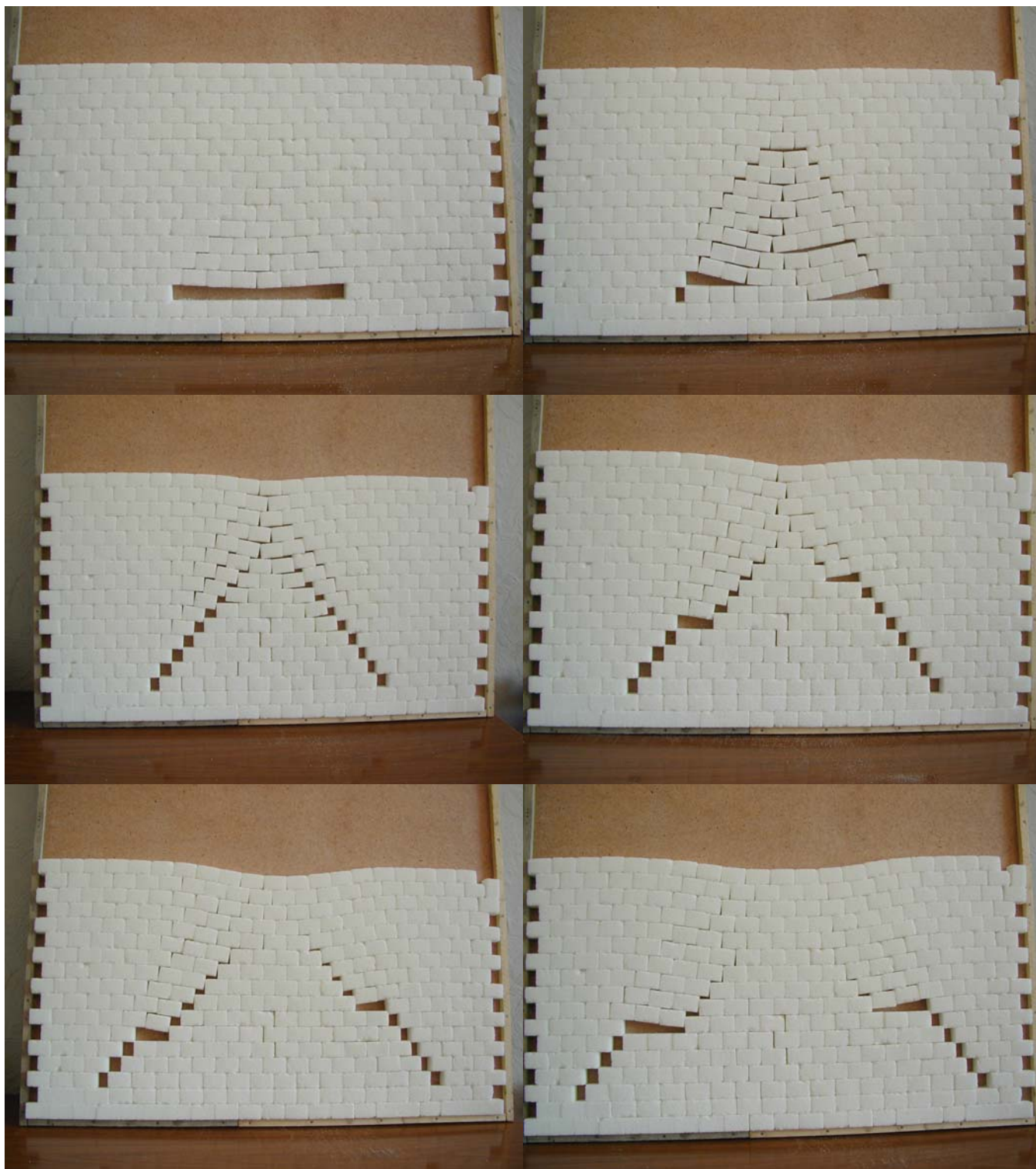
Рис.7. Развитие зоны обрушения при последовательном увеличении ширины выработки высотой 1 блок. Массив сформирован прямоугольными блоками таким образом, что большая сторона блоков расположена горизонтально.
