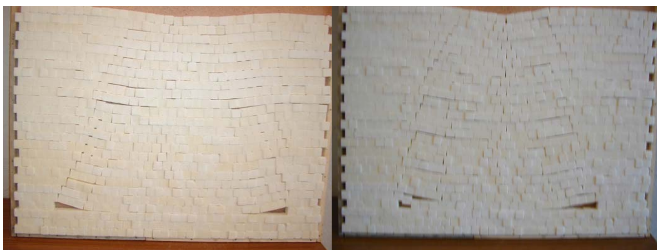
Рис.3. Сопоставление зон расслоений над выработками высотой в 1 блок и шириной 27 (Слева) и 23 (справа) блоков.
