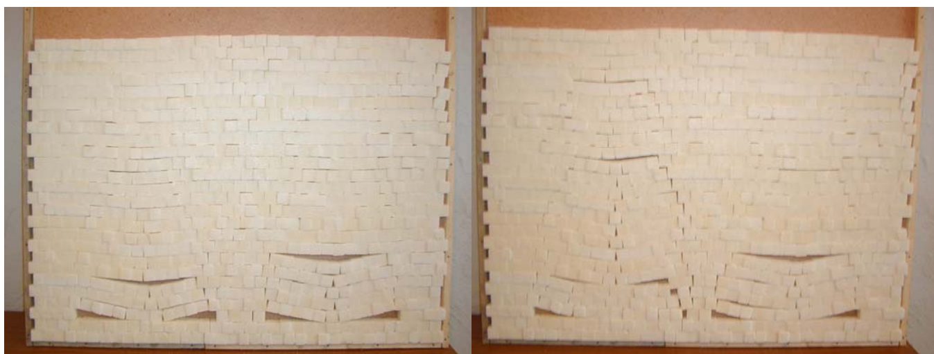
Рис.4. Выработки высотой в 1 блок разделены целиком шириной в 4 блока (слева) и шириной в 2 блока (справа). Ширина выработок – 12 блоков (слева) и 13 блоков (справа).
